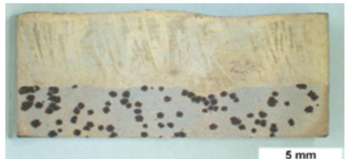
Figura 1. Resultado del ensayo de *metal dusting* de una deposición por soldadura de HR-235 sobre una base de aleación 230 afectada por las picaduras resultantes del ensayo.
