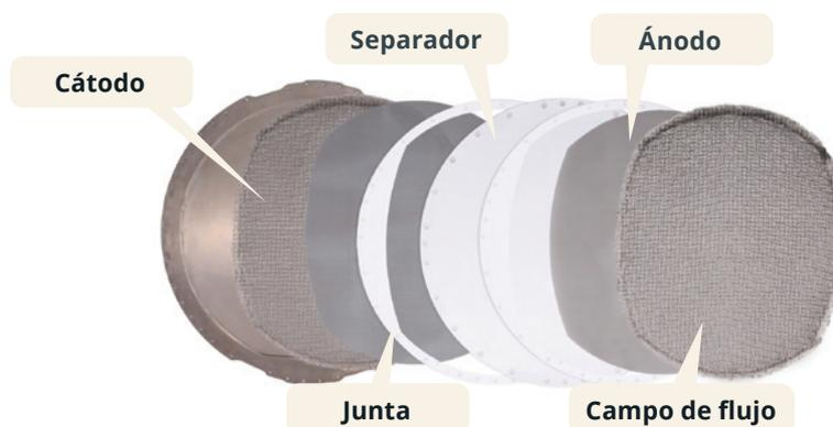
El campo de flujo consiste en una malla suelta de níquel, para permitir el fácil transporte del electrolito y los gases desprendidos. El ánodo suele ser una malla de níquel compuesta por fibras sinterizadas, mientras que el cátodo es una malla similar de fibras de níquel recubierta con un catalizador. Estos catalizadores son propiedad del proveedor, pero el NiFeOx se utiliza habitualmente.
