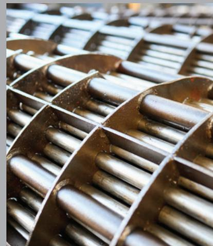
*Las aleaciones de tipo B se han utilizado principalmente en entornos de ácido clorhídrico y sulfúrico, así como en ácidos acético, fosfórico y fórmico. Las aplicaciones específicas incluyen recipientes de reacción, intercambiadores de calor, válvulas, bombas y tuberías.*
