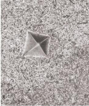
Abdruck in einer oberflächen-gehärteten Probe nach einem Vickers-Härtetest. Sowohl die Längendifferenz der beiden Diagonalen als auch die unterschiedlichen Helligkeiten der Flächen sind klassische Indikatoren dafür, dass es sich um eine unebene Probe handelt, die keinen sachgerechten Abdruck entstehen lässt.
