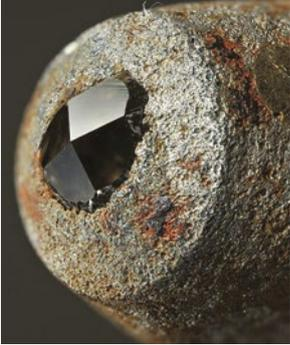
Pyramidenförmige Spitze eines Vickers-Härtetesters
