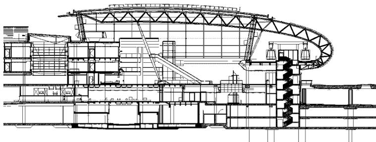
der in das Flughafengebäude integriert ist. Die so entstandene Röhre ist außen mit horizontal angeordneten Edelstahlrohren (Werkstoff-Nr. 1.4404) verkleidet.
