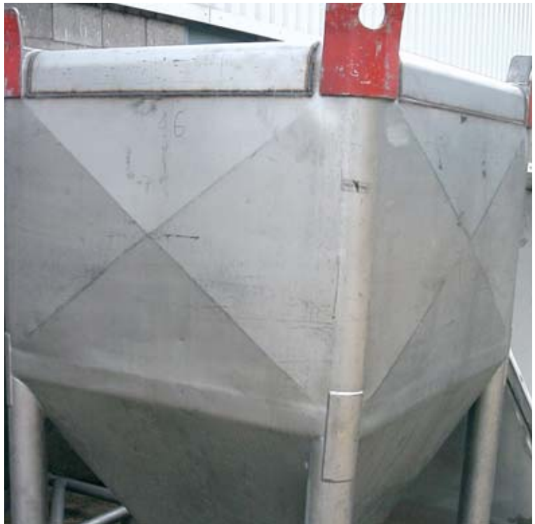
Ruostumattomasta teräksestä valmistettu siilo ennen puhdistusta ja peittautta. Pinnassa on merkkauksia, peitattuja alueita ja hitsauksen aiheuttamia värjäymiä. Jos pintoja ei käsitellä riittävästi hyvin ennen siilon käyttöön ottoa, voi korroosio johtaa koko systeemin ennenaikaiseen vaurioon.
