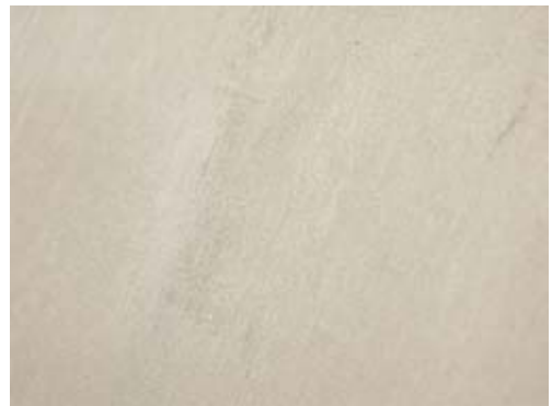
Hehkutettuihin tuotteisiin syntyy hilseenpoiston ja peittauksen jälkeen mattamainen harmaa pinta
