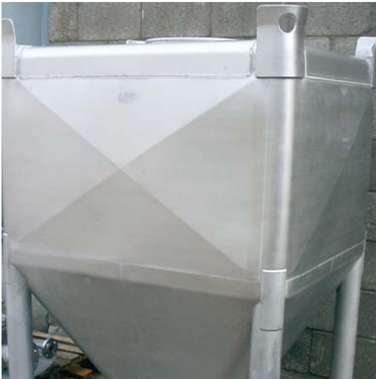
Puhdistuksen, peittauksen ja passivoinnin ansiosta syntyy virheetön ja yhtenäinen pinta. Tämä näyttää hyvältä ja tuotteen korroosionkestävyys on teräslajiin suhteutettuna optimaalinen.
