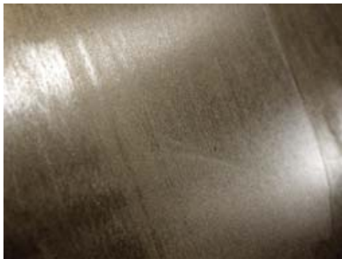
Ruostumattoman teräksen pintaan syntyy kuumavalssauksessa tai kuumamuovauksessa harmaa/musta hilse. Tämä luja oksidikerros poistetaan erikseen hilseenpoistotekniikalla.
