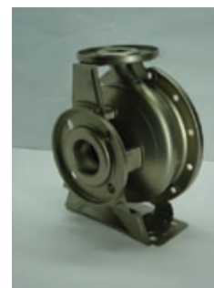
Těleso vyrobené mj. hlubokým tažením z korozivzdorné oceli
