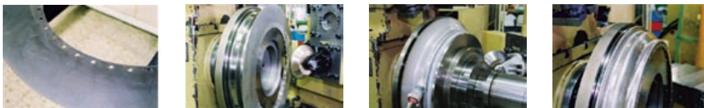
Rotační tváření vnějšího ráfku. Zpevnění korozivzdorné oceli tvářením zvyšuje její schopnost pohlcovat nárazy.
