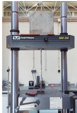
Figura 1. Configuración de la prueba de extracción
